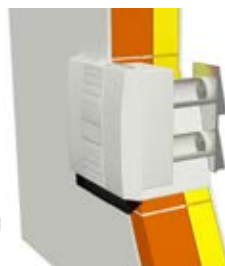
Montáž pod omítku
