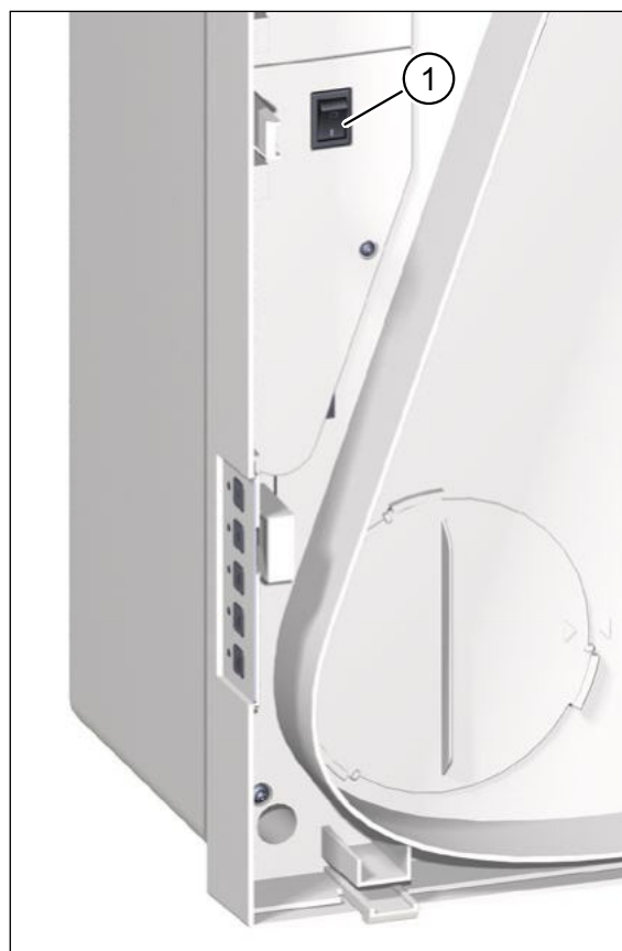
Obr. 17: Síťový spínač, viditelný po sejmutí víka přístroje
