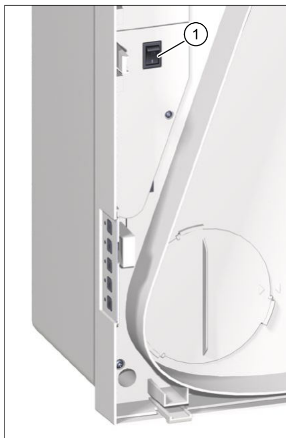
Obr. 13: Síťový spínač, viditelný po sejmutí víka přístroje
